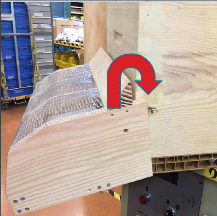
Arrimage très rapide et simple : par un piton crochet (flèche rouge) inséré dans un piton œillet vissé sur la ruche
